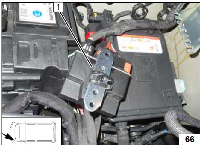
1 Кронштейн блока реле в сборе
