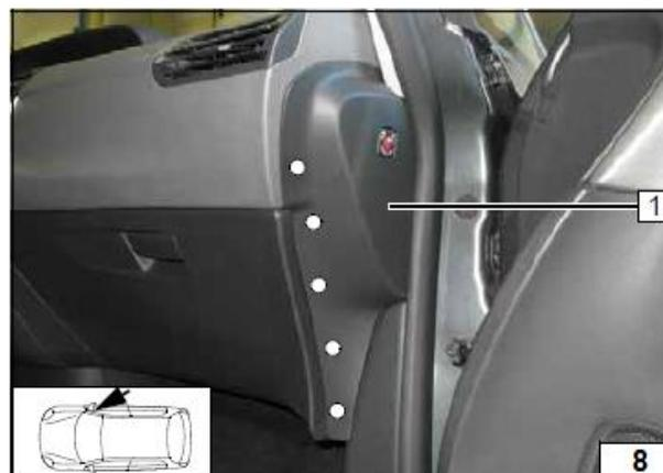
Снять обшивку центрального бокса (точками отмечены защёлки крепления).
