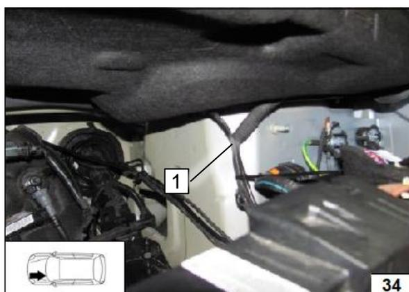
Вывести жгут **1** из-под пыльника и провести вдоль тормозных трубок в нижнюю часть автомобиля.
