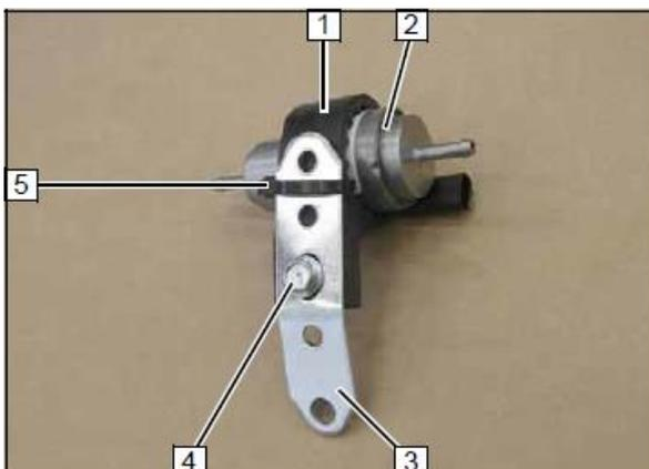
Закрепить насос 2 болтом 1 крепления топливного бака.
